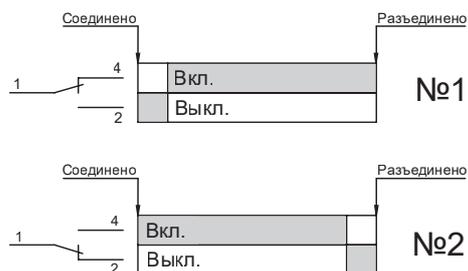
Данные контакты сигнализации устанавливаются в корзине и служат для индикации положения автоматического выключателя. 1 – "Разъединен"; 2 – "Соединен"
